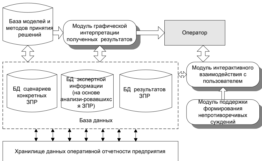
Рис 5.6. Структура программного обеспечения СППР "Выбор"
